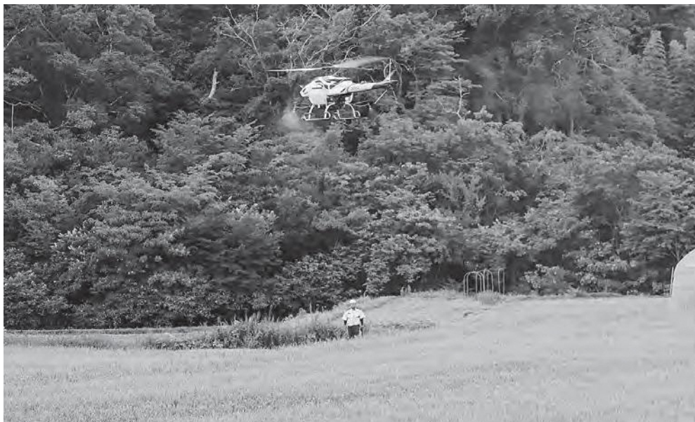
無人ヘリコプターによるカメムシ類防除薬剤散布
