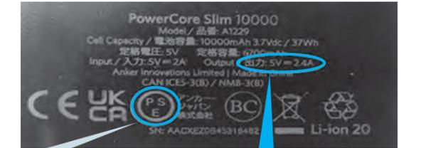
充電前に必ず充電器の「出力電圧・電流」とバッテリーの「入力電圧・電流」が同一であることを確認してください。
