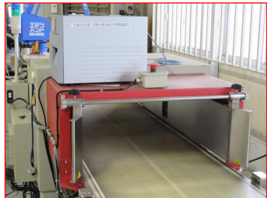
ベルトコンベア式放射性セシウム濃度検査器（福島さくら農業協同組合楡葉支店）
