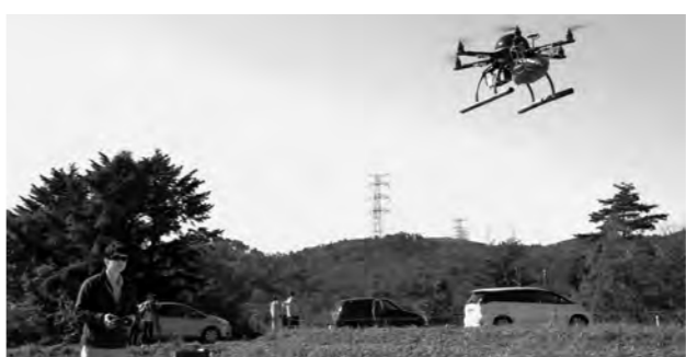
除染等検証委員会によるラジコンヘリを使ったモニタリング調査
