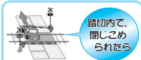
あわてずに車をゆっくり前進させてください。車が踏切内から脱出できるよう、しゃ断棒は前方に跳ね上がったり、折れるようになっています。
