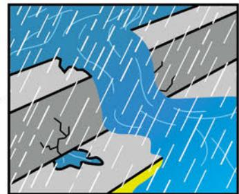
水が増え、水の力に堤防が耐えられなくなり堤防の一部が崩れ始めます。
