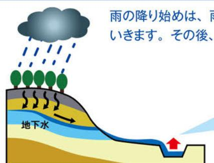
雨の降り始めは、雨水が地中へと浸透していきます。その後、地表面を流れ出します。
